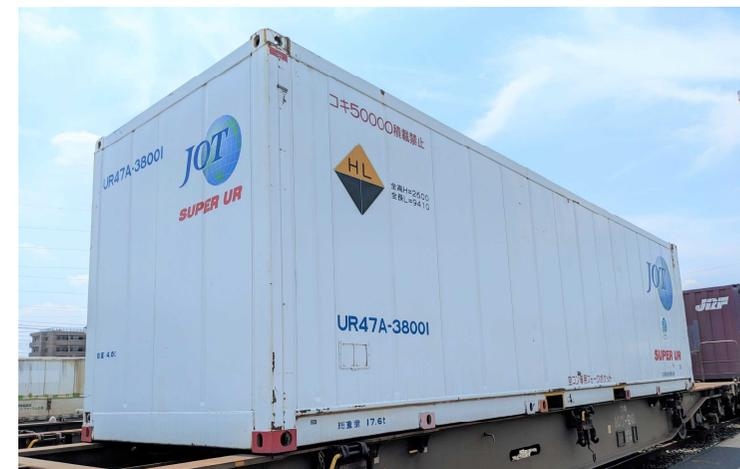
スーパーURコンテナ: 日本石油輸送が所有する真空断熱パネルを採用したコンテナ。冷蔵コンテナよりも高い断熱性能を備えているため、温度維持が必要な品物を運ぶ場合に適する。
