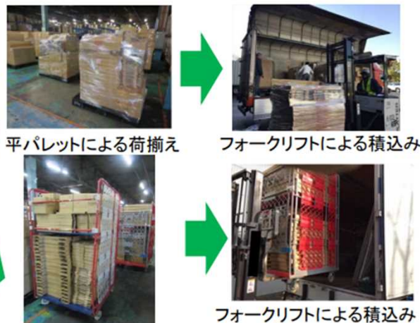
付属品のばら積みイメージ ロールボックスパレットによる荷揃え
