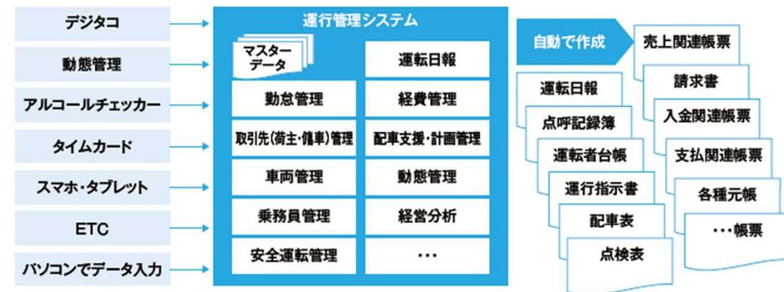
**システム概要** 運行管理システムとは、運行に関わる業務システム全般を指します。一般には、トラック輸送ならではの運送関連業務システムと、関連する帳票作成等の事務作業システムを連携させたものを指します。
