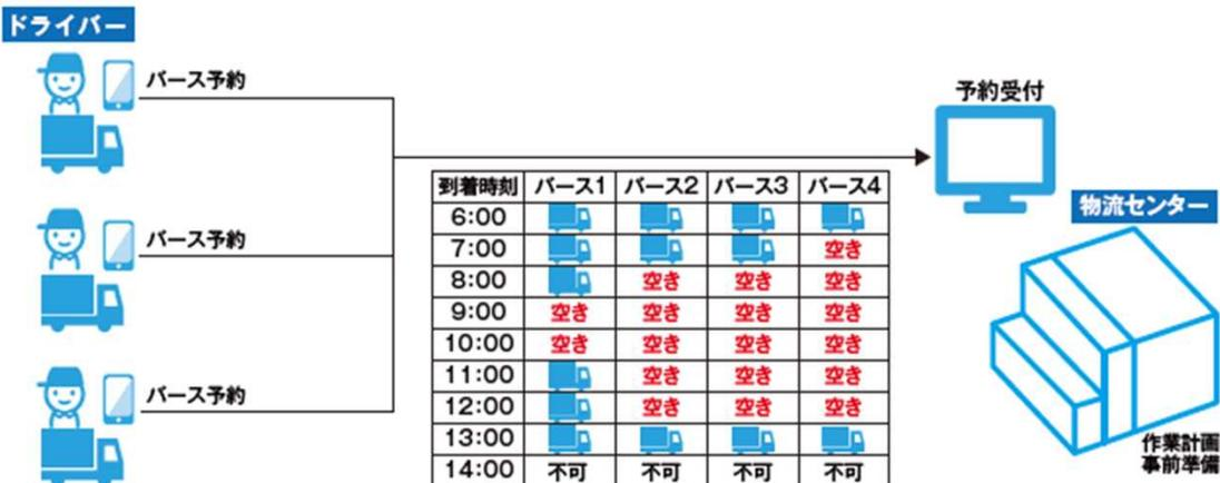
**システム概要** バスの空き状況を管理し、予約を受け付けるシステム。トラック側が物流施設への到着時刻等をスマートフォン等の端末から事前予約、物流施設側はトラックの入出情報を事前照合するとともに予め作業準備することでトラックの待機時間削減と物流施設側の作業効率アップの両立を図ります。
