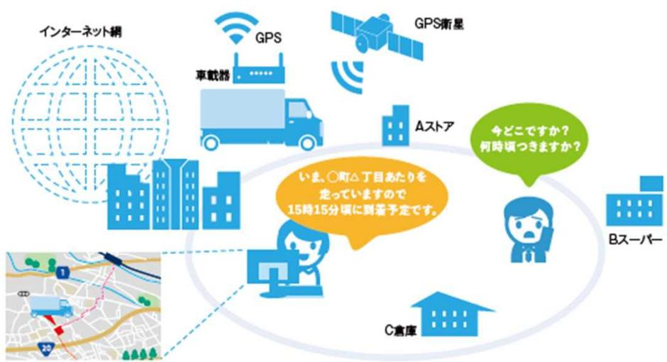
**システム概要** 車両が現在どこにいるのか、どのような運行状況にあるのかを確認するシステム。GPS機能の搭載された車載端末等から携帯電話等のデータ通信機能を利用し、インターネットを介して、車両の位置や運行状況などのデータを受信することにより管理を実現しています。
