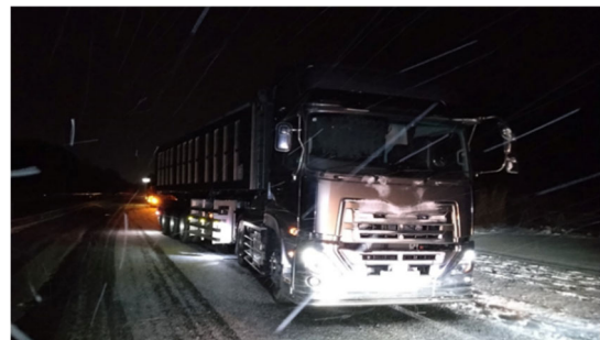
【写真②】 ノーマルタイヤの スタック状況
