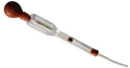
蓄電池の電解液の比重測定用のもので、電解液吸出し用のスポイトの中に比重計が入っているもの。このスポイトは対象とする自動車の蓄電池電解液の容量に応じたものであること。
