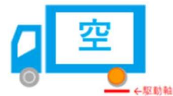
駆動軸に十分な荷重がかからず、発進性能が低下。
