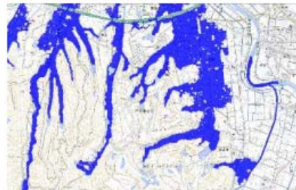
ため池決壊による危険性のある区域
