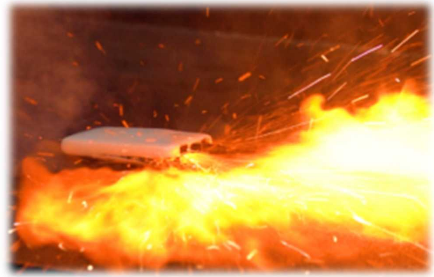
● モバイルバッテリーの発火状況 (写真提供：NITE)
