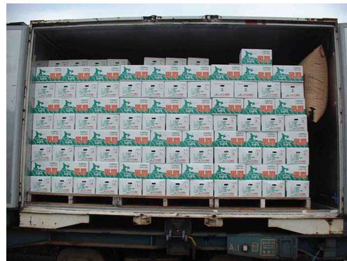
JRコンテナ 新段ボール+エアバック 市場着荷状態
