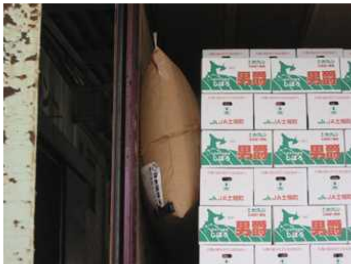
JRコンテナ 新段ボール+エアバック 積み上げ設置状態
