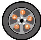
仮止めの順番(5穴)
