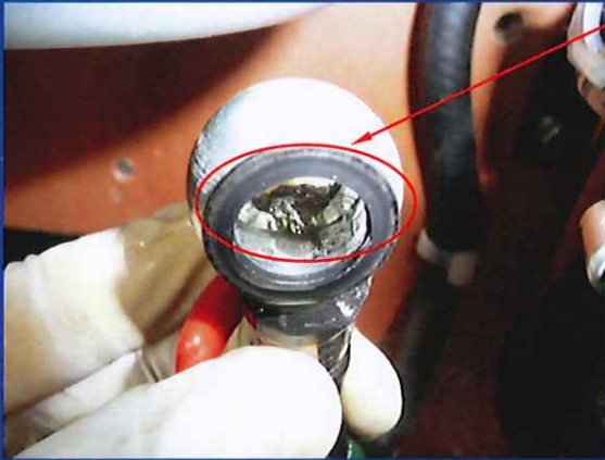
・冷却水ポンプのインペラ破損
