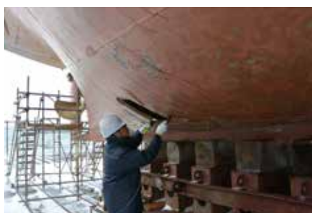
船底外板を検査する船舶検査官
