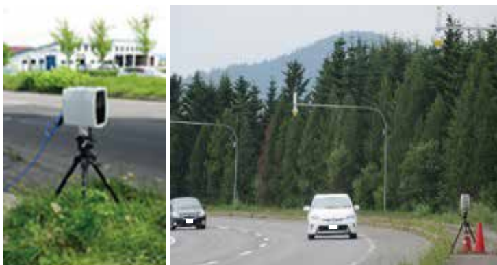
可搬式ナンバー自動読取装置による無車検車両の捕捉
