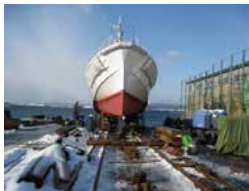
造船所職員を帯同し冬場に漁船の船体外板を検査する船舶検査官
