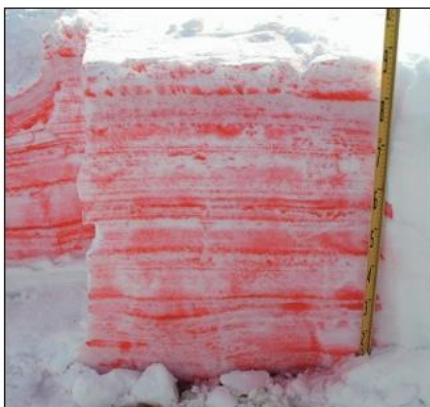
インク法による積雪断面の層構造の観察 3)
