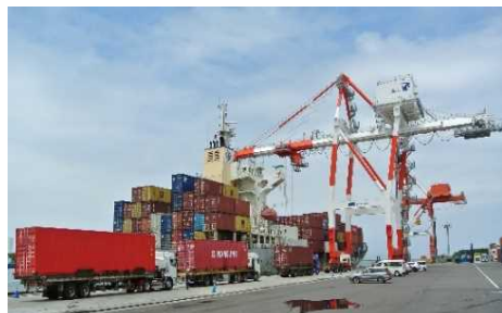
ガントリークレーンによるコンテナ荷役作業 （写真提供：石狩湾新港管理組合）
