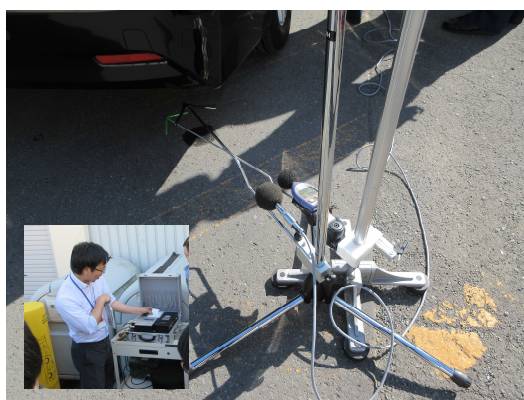
マフラー騒音の測定実習の様子
