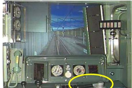
電車運転シミュレータの運転台
