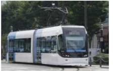
LRT ( Light Rail Transit )<br>: 低床式車両の活用等による地域の幹線交通システム<br>BRT ( Bus Rapid Transit )<br>: 連節バス、バスレーン等を組み合わせた地域の幹線交通システム |
