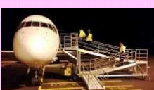
・スロープ型タラップの整備
