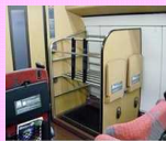
・鉄道車両の荷物置き場の設置
