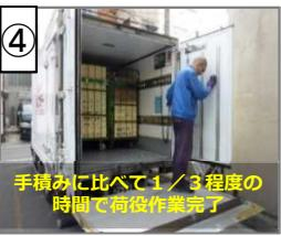
④ 手積みに比べて1/3程度の時間で荷役作業完了
