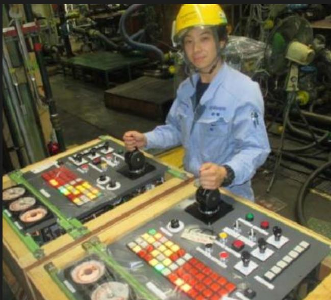
私は、生産工場でエンジンの試運転業務に携わっています。試運転業務は、組立工程を終えたエンジンをお客様の仕様に満足させるべく試運転調整を行います。
