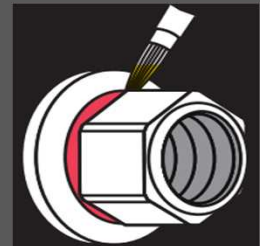
錆びたナット裏面 (車輪脱落事故車両調査より)
