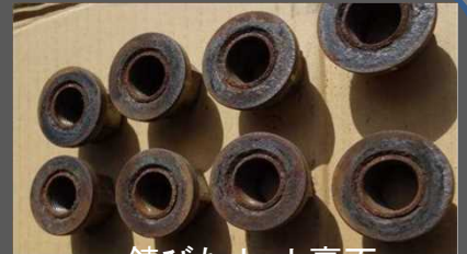
錆びたナット裏面 (車輪脱落事故車両調査より)
