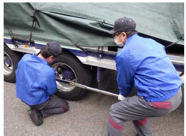
増し締め点検の様子
