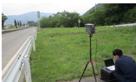
ナンバー自動読取装置設置状況
