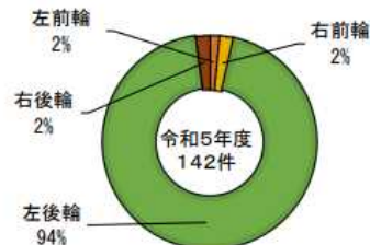
脱落した車輪位置
