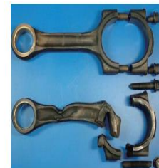
メタルが焼き付き 破損したコンロッド
