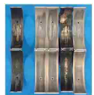
オイル劣化で摩耗・破損したコネクティングロッドメタル
