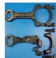
メタルが焼き付き破損したコネクティングロッド
