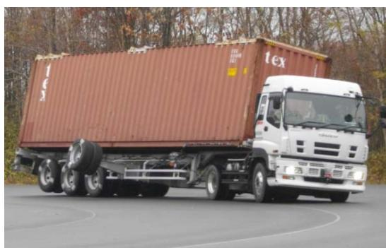
40ft3 軸トレーラー(アウトリガつき)実験用車両による横転限界時の様子。
