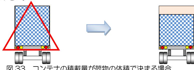
○ケース3：重量と体積いずれもフル積載状態となるような場合（例：サクラの製材など）、積載量を分散するなど、重心位置が高いコンテナが発生しないよう配慮し、可能な限り安全が確保されるようご協力下さい。
