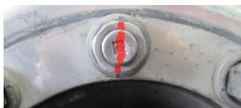
○ホイール・ナットの回転を指示するインジケータ類の装着
