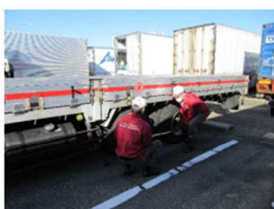
ホイール・ナット 締付状況 確認
