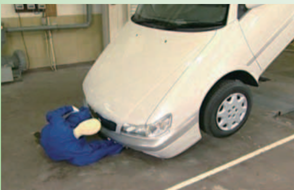
荷重バランスが悪い状況でのリフトアップによる車両落下検証実験写真 (提供：自動車用品小売業協会)
