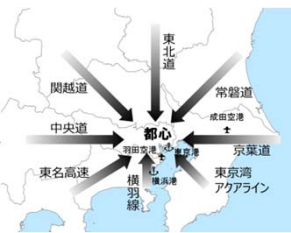
図 首都直下地震に備えた“八方向作戦”による道路啓開
