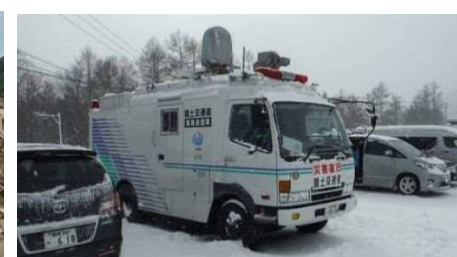
衛星通信車による火山監視映像の通信体制確保
