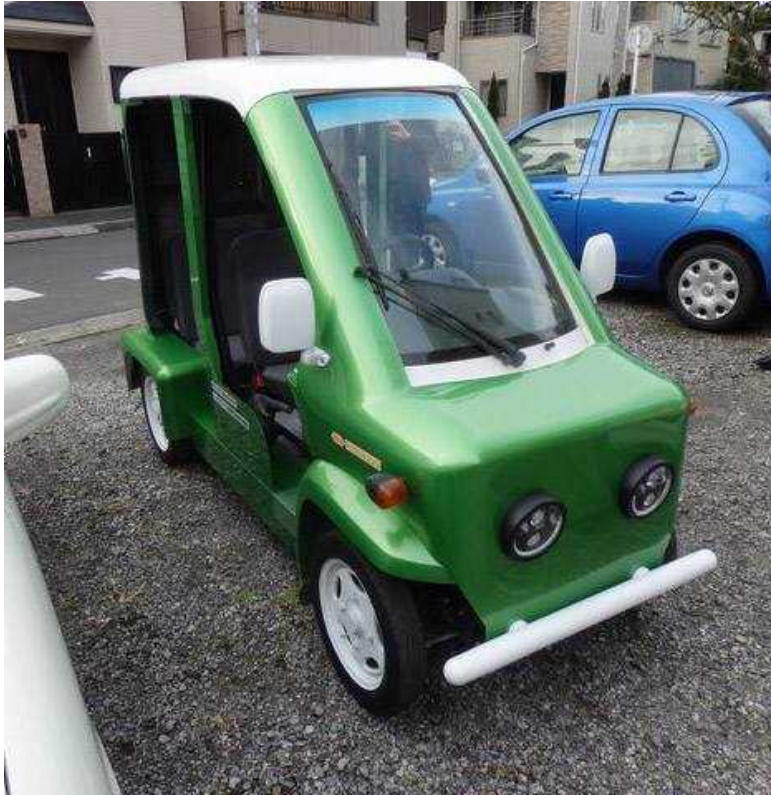
江戸川号：旧型コムスに「NNC風」のオールアルミ車体を載せたもの。 (製作期間1カ月)
