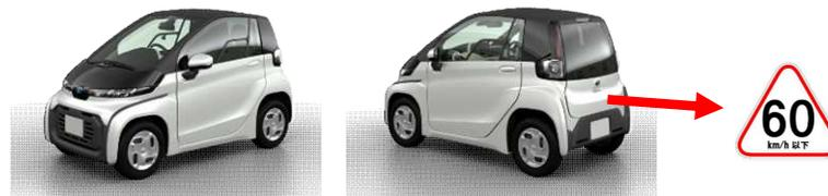
車検証の備考欄に「この自動車の装置の一部は、長さ2.5m、幅1.3m、高さ2mを超えない軽自動車であって、最高速度60km毎時以下のもののうち、高速自動車国道等において運行しないものとして基準への適合性の判定を行っています。」を記載
