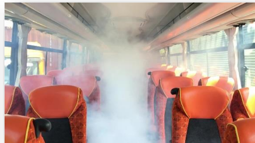
車内のスモークは約5分でクリアに(換気性能実験)
