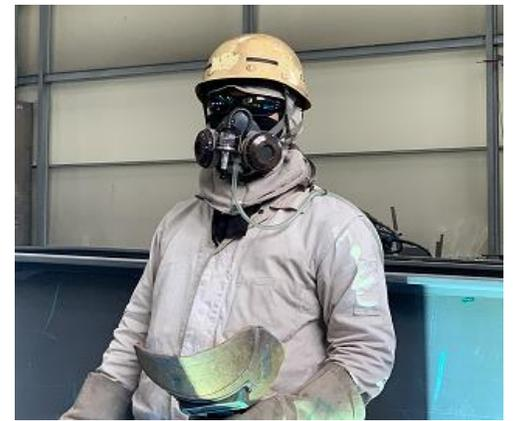
図10 不適切な測定機材（採取口）の装着例（採取口が溶接用の面体の内側に位置できない）
