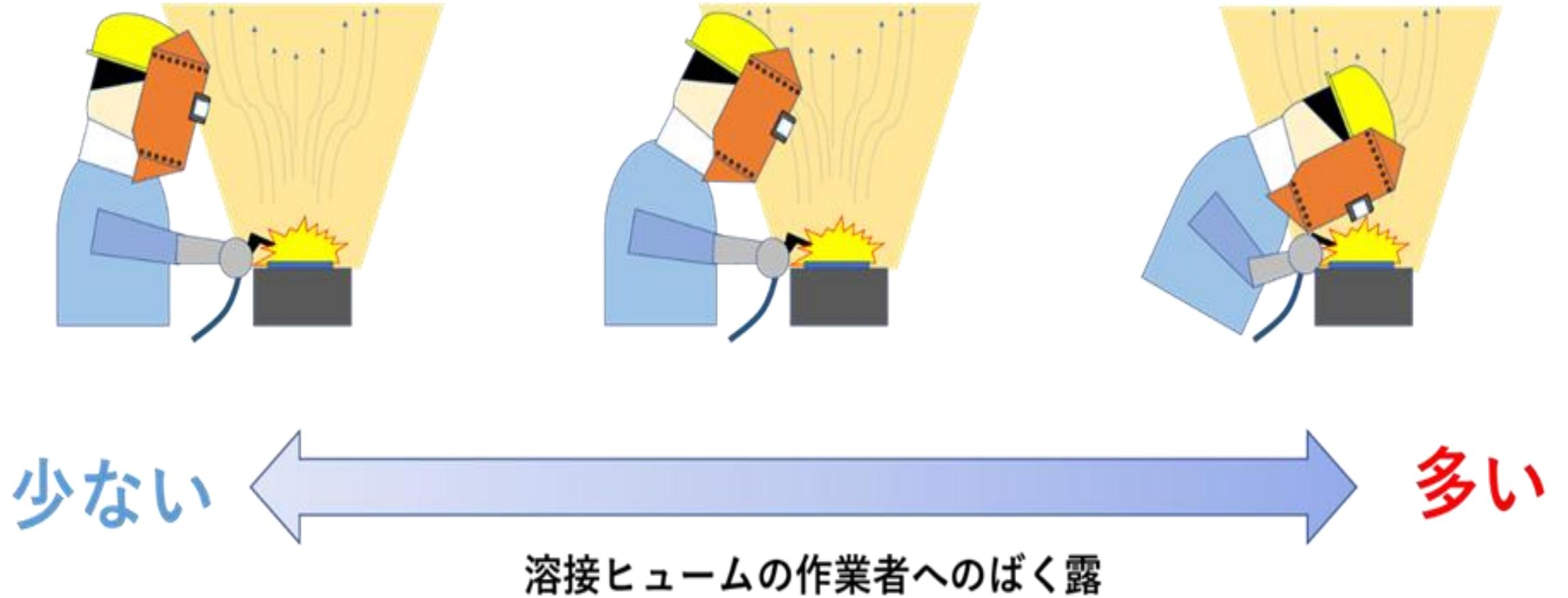
図11 溶接ヒュームの作業者へのばく露イメージ
