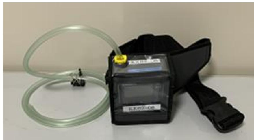
図8 測定機材（小型ポンプ及びチューブ）
