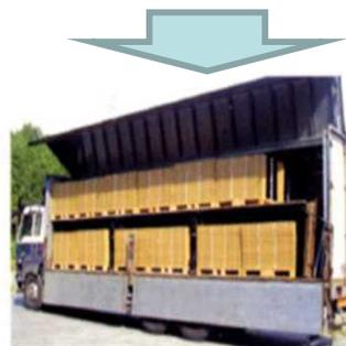
● 荷物を2段積みすることが可能となるため、**約2倍の積載量が実現され、生産性向上に繋がる**。
