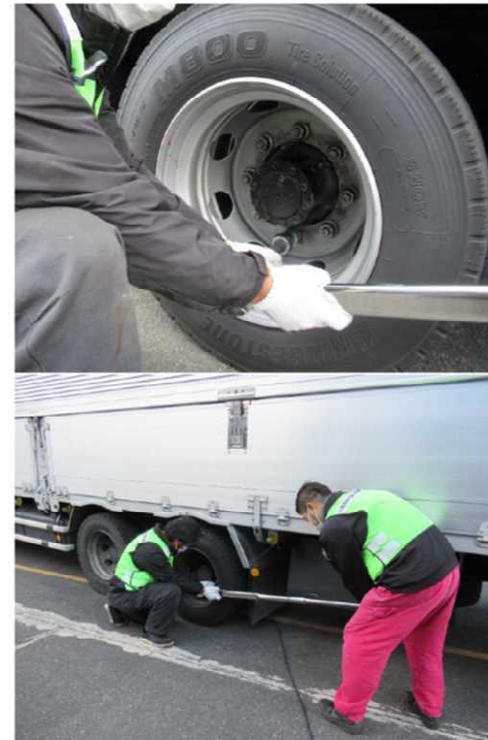
ホイールナットの締め付け状態の確認
