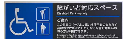
施設の入口近くの駐車区画数が僅かであることから、車椅子使用者以外の障害者等を車椅子使用者用駐車施設の利用対象者とする場合に、誤認等が無いよう、利用対象者をピクトグラム等で分かりやすく明示している事例
