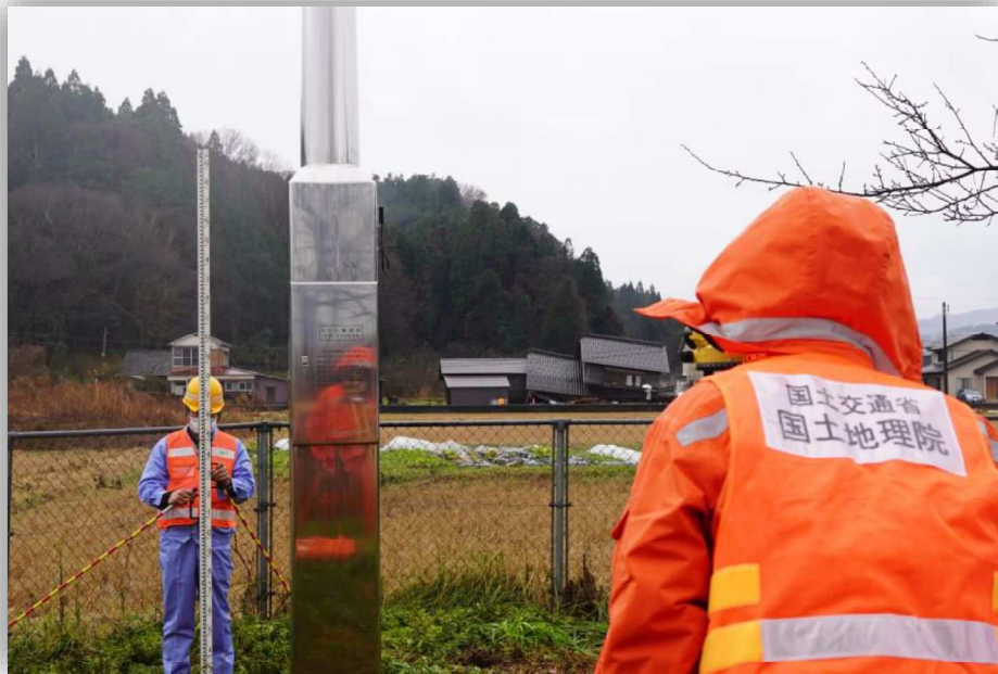
緊急測量調査班による電子基準点（輪島）の現地調査
