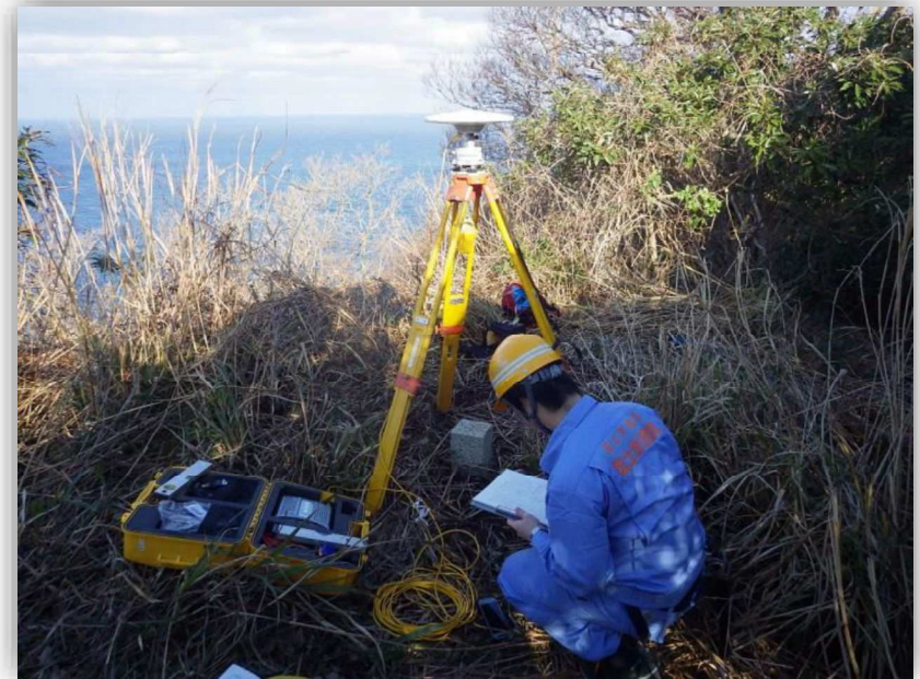
被災状況調査班による地殻変動把握のための緊急測量（輪島市）
