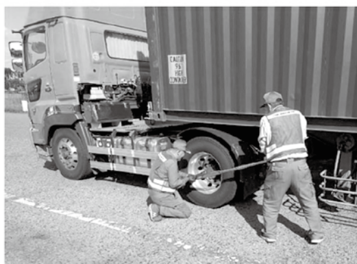
トルク・レンチを使用した街頭点検
