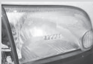
内部リフレクタの劣化
