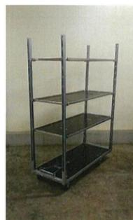
(写真左) フル台車 : W1055mm×D1285mm×H2068mm
