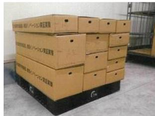
(写真はT11パレットに4種類の切り花標準箱を積み上げた様子▲)
