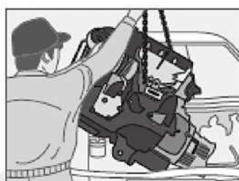
1 原動機 (エンジン脱着)
