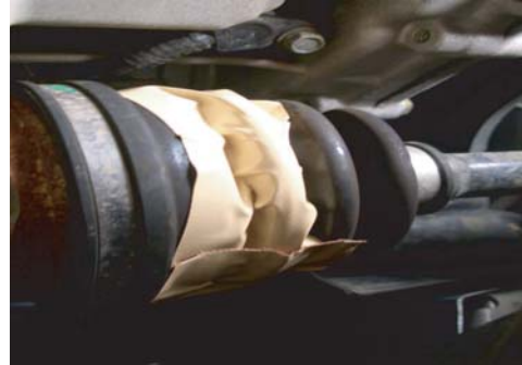
粘着テープによる補修
