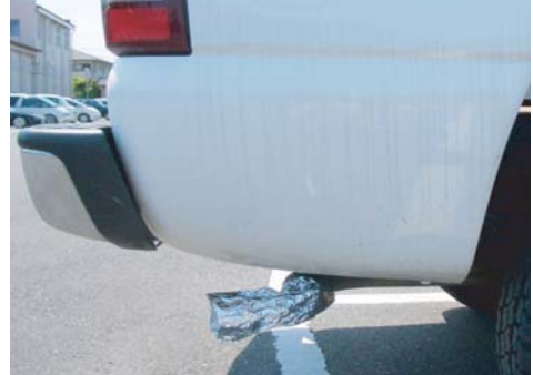
金属箔による排気管の開口方向の変更
