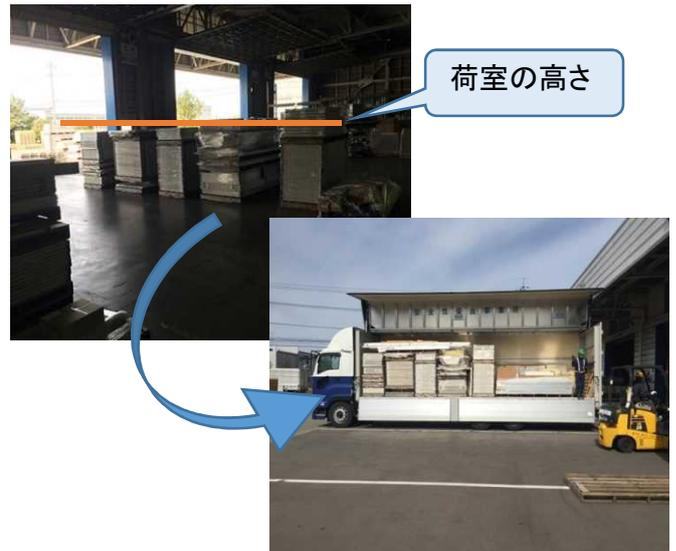
出荷に合わせた生産体制を確立、ピッキング作業の減少と車両にあわせた取り纏めにより積み込み作業時間が削減された
