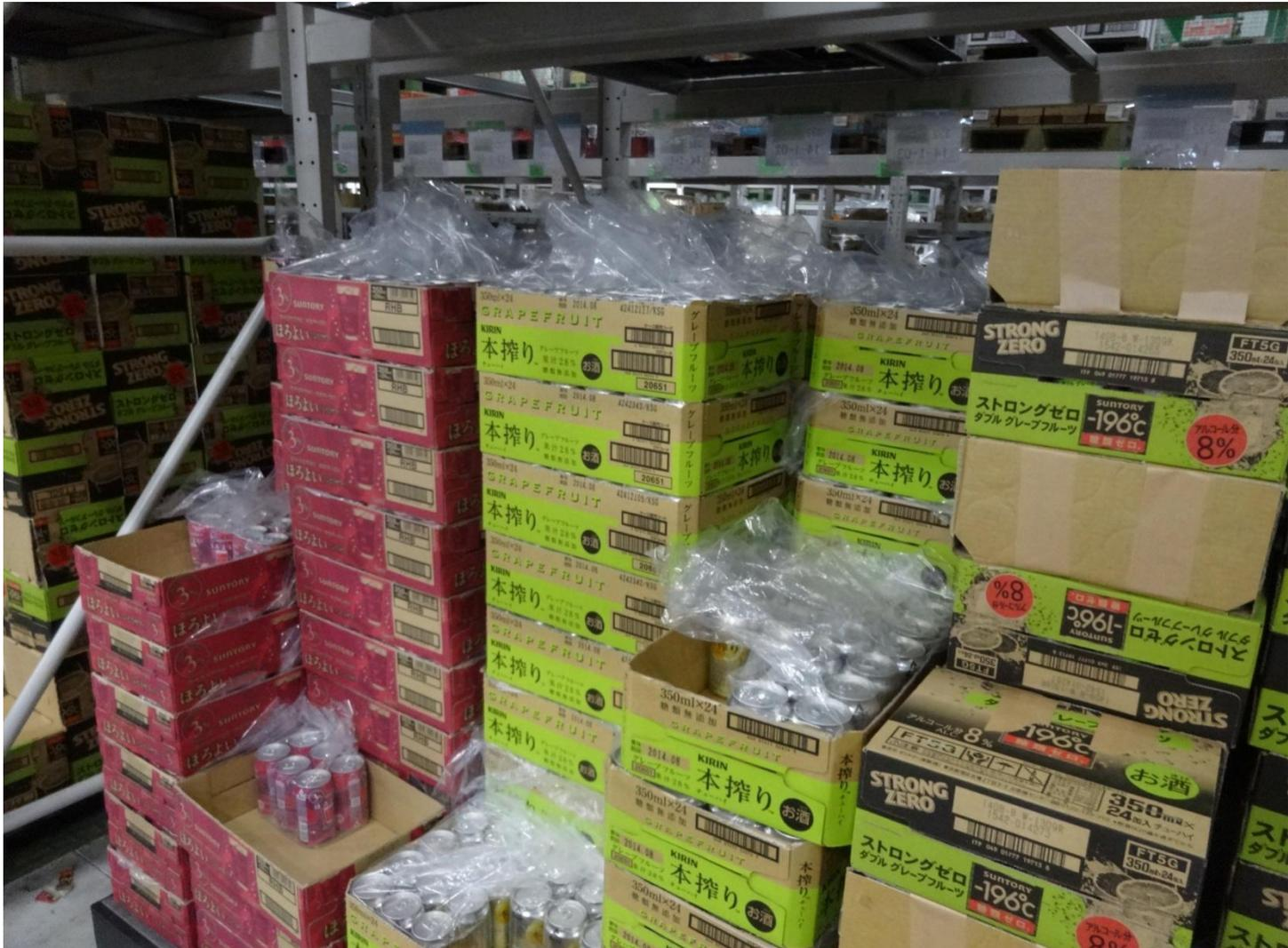
食品卸のセンターで段ボールの飲料を6個単位にビニール袋に入れ替えている
