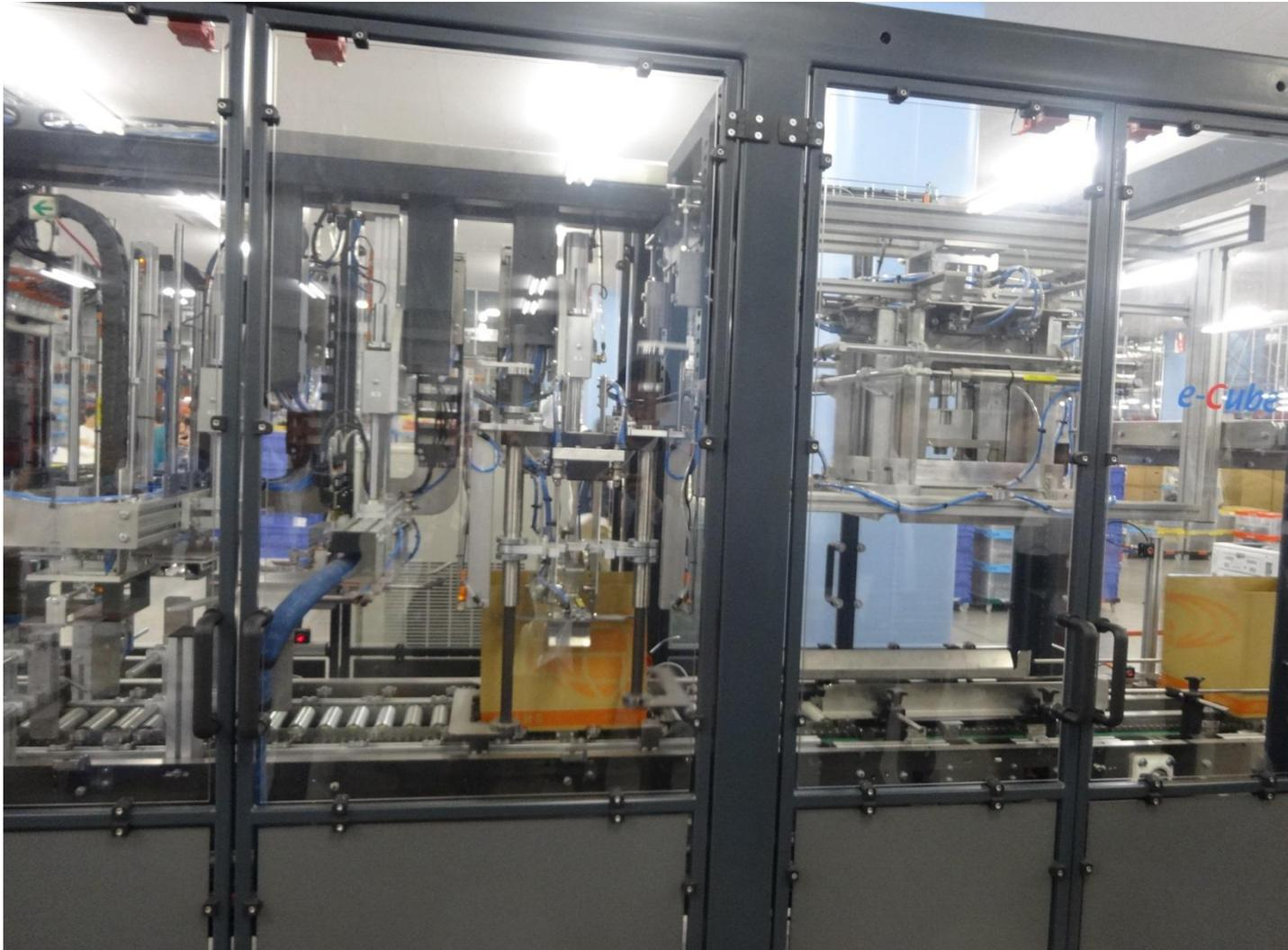
荷物の高さを測定して段ボールの深さを変えて封をする
