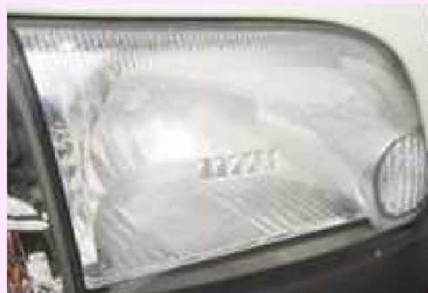
内部リフレクタの劣化
